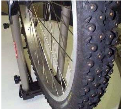
Abbildung 3: Felge mit Spikereifen für Schnee und Eis.
