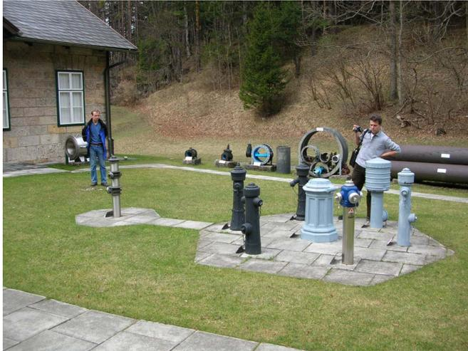
**Abb. 14 : Ausgestellte Rohrmaterialien und Hydrantentypen im Freilichtbereich**
